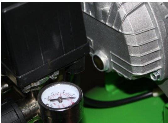
Izpuščeno olje ujemite v posodo in ga strokovno odstranite. Ponovno zaprite izpustni vijak. Sedaj lahko v rezervoar vlijete svežo motorno olje in zaprete odprtino za vlivanje olja. Pustite stroj teči 10 minut v prostem teku (glej poglavje Prva uporaba: Kontrola podmazovanja) in zatem še enkrat preverite nivo olja. Preverite, če Vaš kompresor ali njegovo neposredno delovno okolje niso zamazani z oljem. To bi namreč bistveno zmanjšalo delovno varnost.
