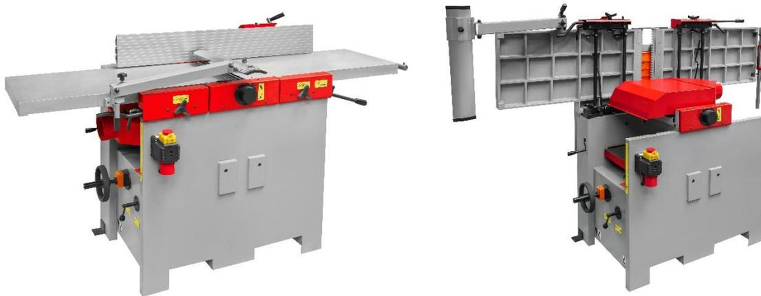
Betreiben Sie die Maschine nicht ohne angeschlossener und eingeschalteter Absaugeinrichtung. Der Absauganschluss hat einen Durchmesser von 120mm.
