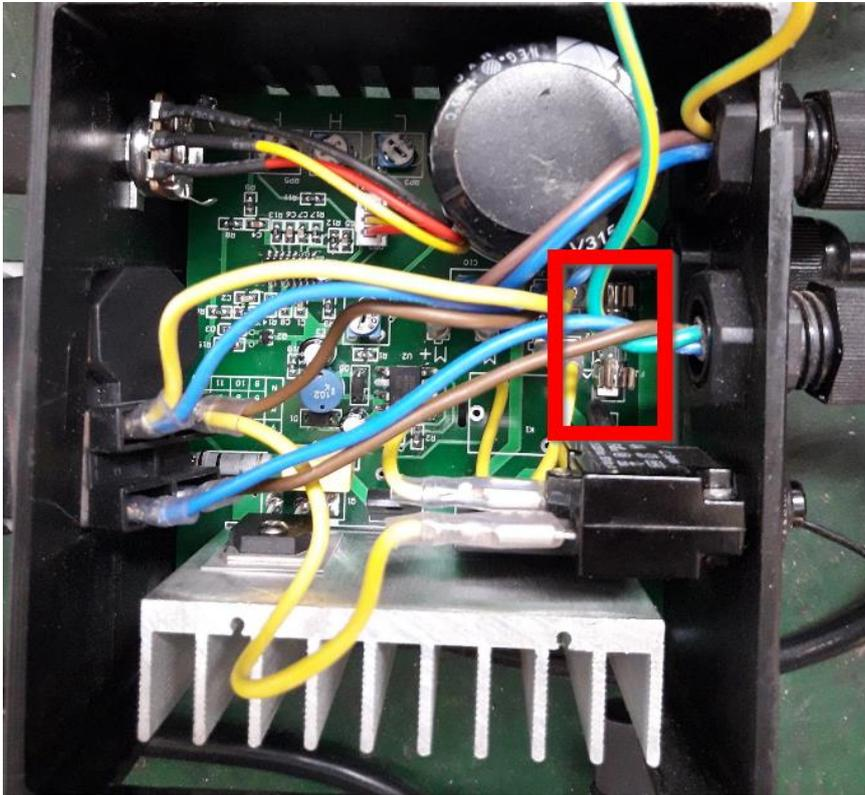
Die defekte Sicherung entfernen und die Neue vorsichtig in den Halter stecken bzw. schrauben.
