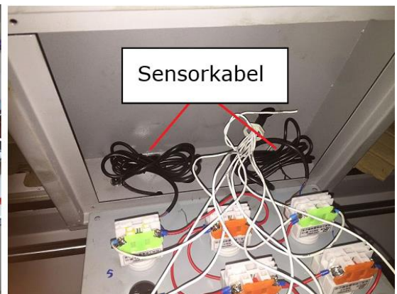
Bedienpanelabdeckung abschrauben und Bedienpanel mit den 3 Schrauben befestigen. Dabei auf Sensorkabel achten!
