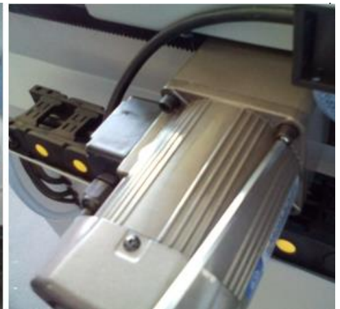
2. Vorschubmotor Mit 4 Schrauben montieren
