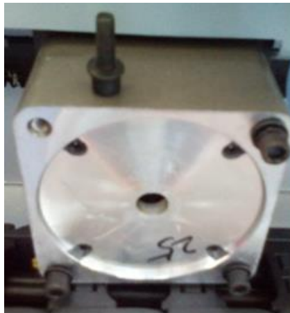
2. Vorschubmotor Mit 4 Schrauben montieren
