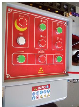
Bedienpanelabdeckung abschrauben und Bedienpanel mit den 3 Schrauben befestigen. Dabei auf Sensorkabel achten!
