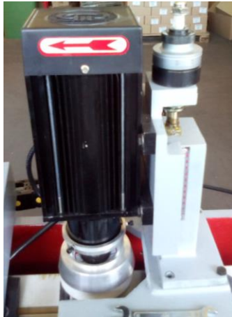
1. Hauptmotor: Mit 4 Schrauben montieren
