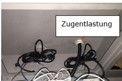
4. Zugentlastung: Zugentlastung des Hauptsteuerkabels anziehen. Bedienpanelabdeckung wieder anschrauben!
