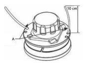
**4.** Den Faden durch die beiden Auslassöffnungen (B, D) ziehen und Fadenspule wieder schließen (C). Um Verwicklungen zu vermeiden an beiden Enden fest ziehen.
