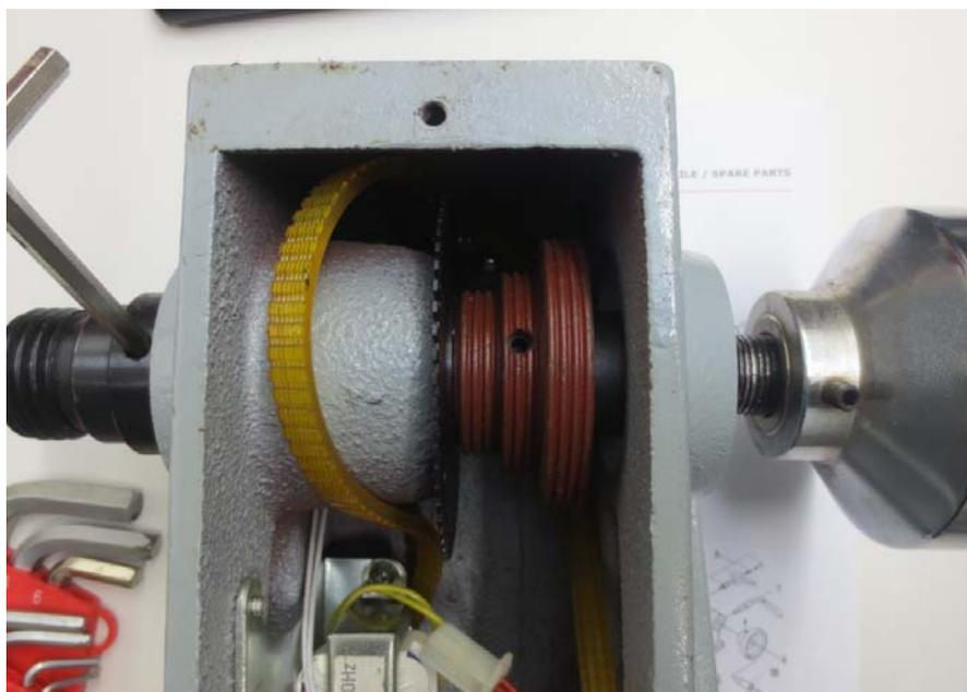
3. Inbusschraube bei Riemenscheibe herauserschrauben und Distanzhülse rechts abziehen.
