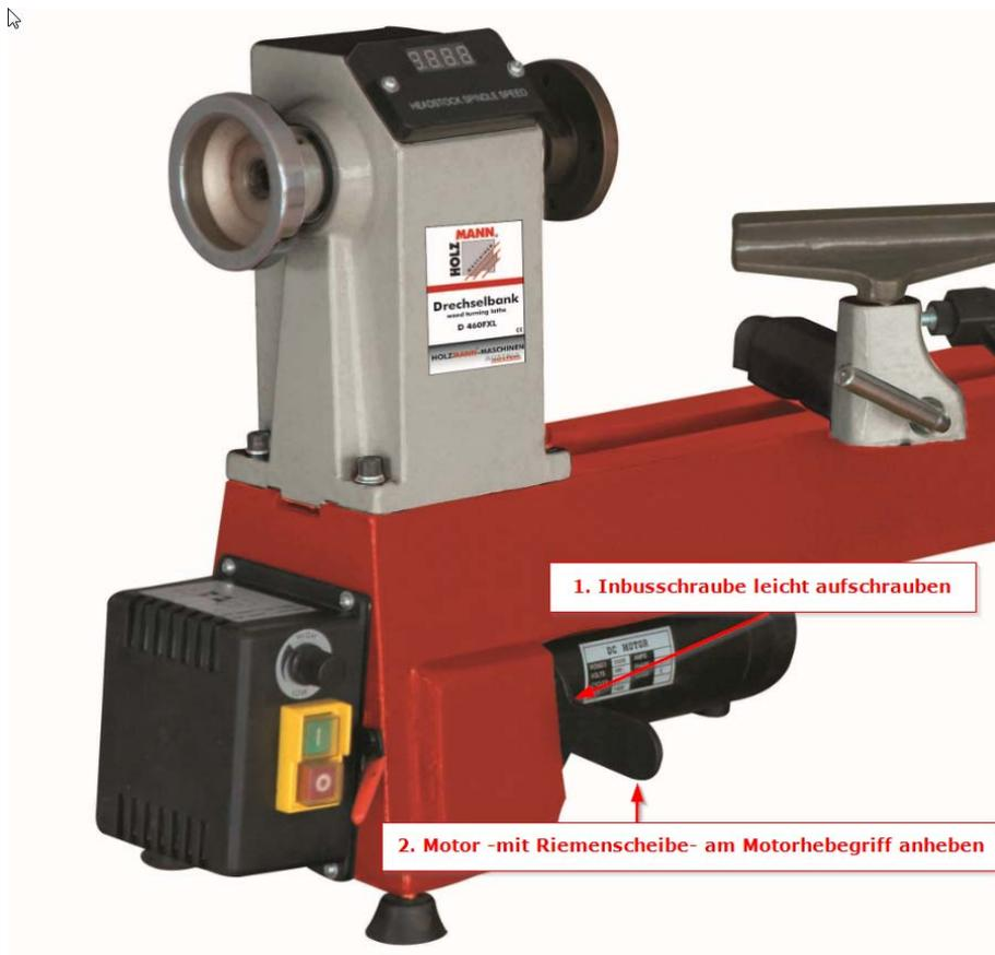
Vor Beginn des Wechsel Abdeckplatte oben hinten abschrauben und die Maschine um 90° umlegen
