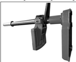
Säule / Grundplatte/ Tisch rausheben Die vormontierte Säule auf Grundplatte mit Tisch aus der Verpackung rausheben. Zum Herausnehmen wird ein Kran mit entsprechendem Hebezeug empfohlen
