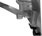
4. Handkurbel für Tisch montieren Handkurbel aufstecken und mit Wurmschraube sichern
