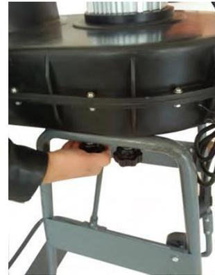
6. Filtersackhalterung am Lüfterradgehäuse montieren.
