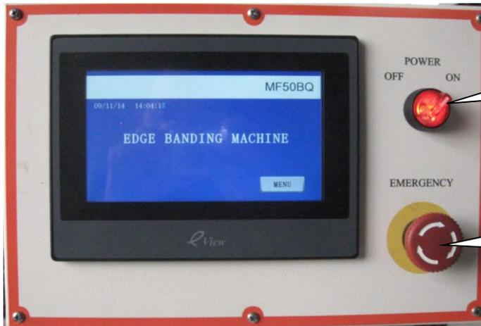
Maschine mit dem **ON / OFF** Schalter starten
