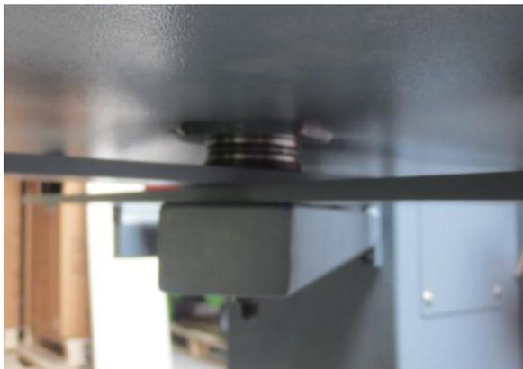
Eines der beiden Axiallager auf die Flacheisen mittig aufsetzen.
